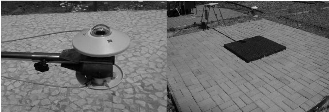
Figura 3: Piranômetro e mistura asfáltica Vermelho A durante o ensaio de refletância em campo
